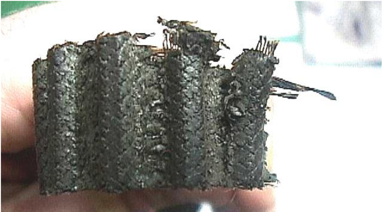
Figura 38: Foto de Correia com desgaste lateral.
