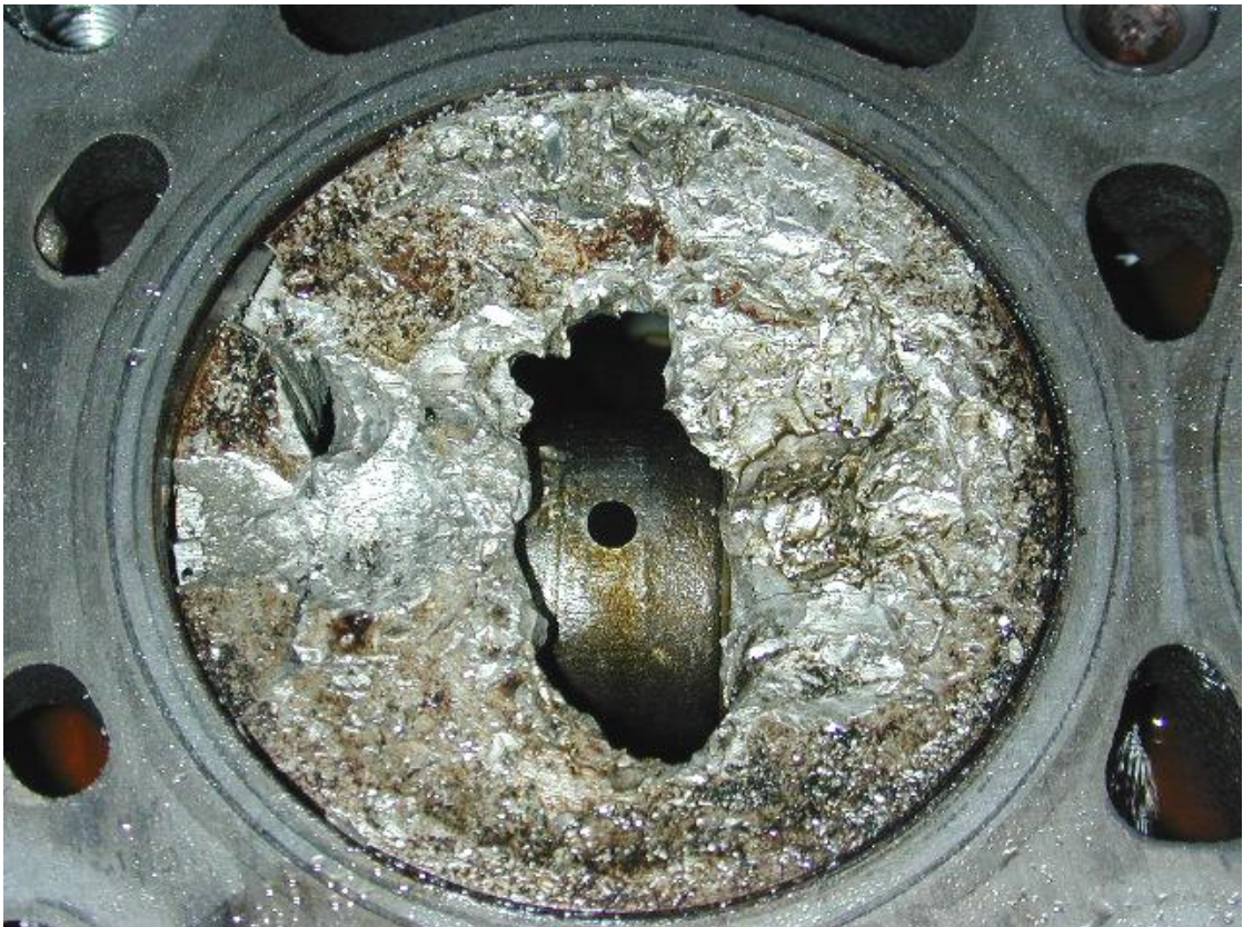
Figura 43: Danos causados em um pistão atingido por uma válvula.
