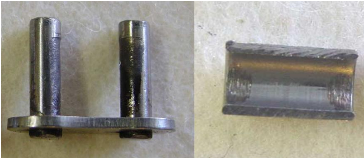
Figura 31: Desgaste de elos e bucha de corrente. (Ragnitz, 1997).
