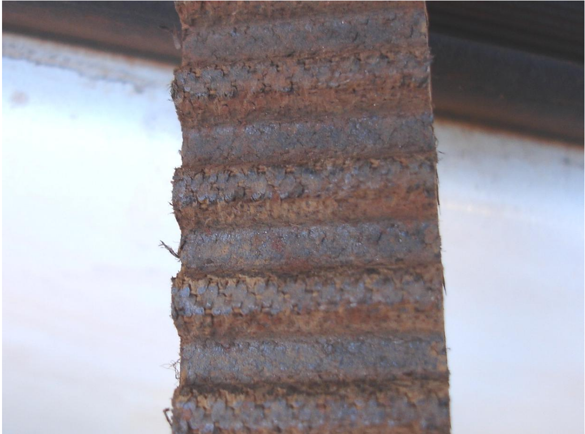
Figura 37: Foto de Correia com desgaste prematura dos dentes.
